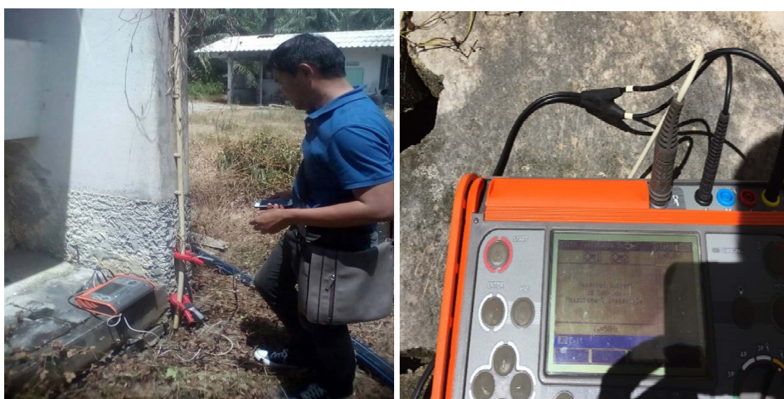
รูปที่ ๓.๑ การตรวจวัดค่าความต้านทานดินอาคารพักพยาบาล(หลังเก่า)
